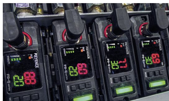
Optionale Ausstattung: wartungsfreie Ultraschall-Durchflussmessung
