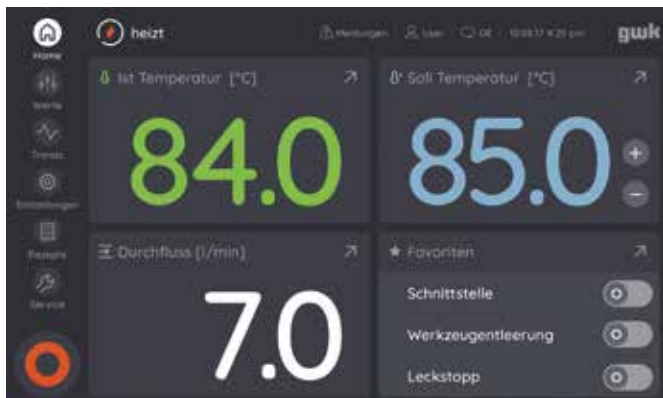
Anzeige- und Bedieneinheit logotherm mit gestenfähigem 7" Multitouchdisplay
