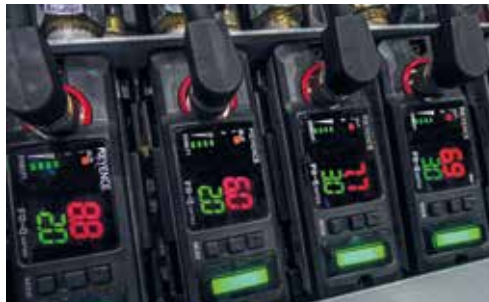
Zusätzlich zur Anzeige im Temperiergeräte-Display: Darstellung der Durchflussmenge und des Status am Sensor
